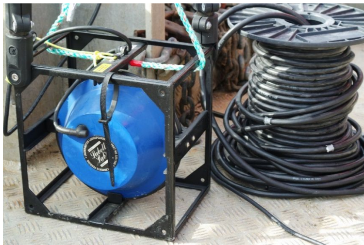
Figure 12. Dispositif d'émission sonore sous-marin avec le HP Lubell.
